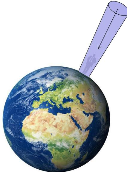
Figure 2 : La pression atmosphérique est engendrée par la masse d'air qui se situe au dessus de nous et qui pèse sur nos épaules.
